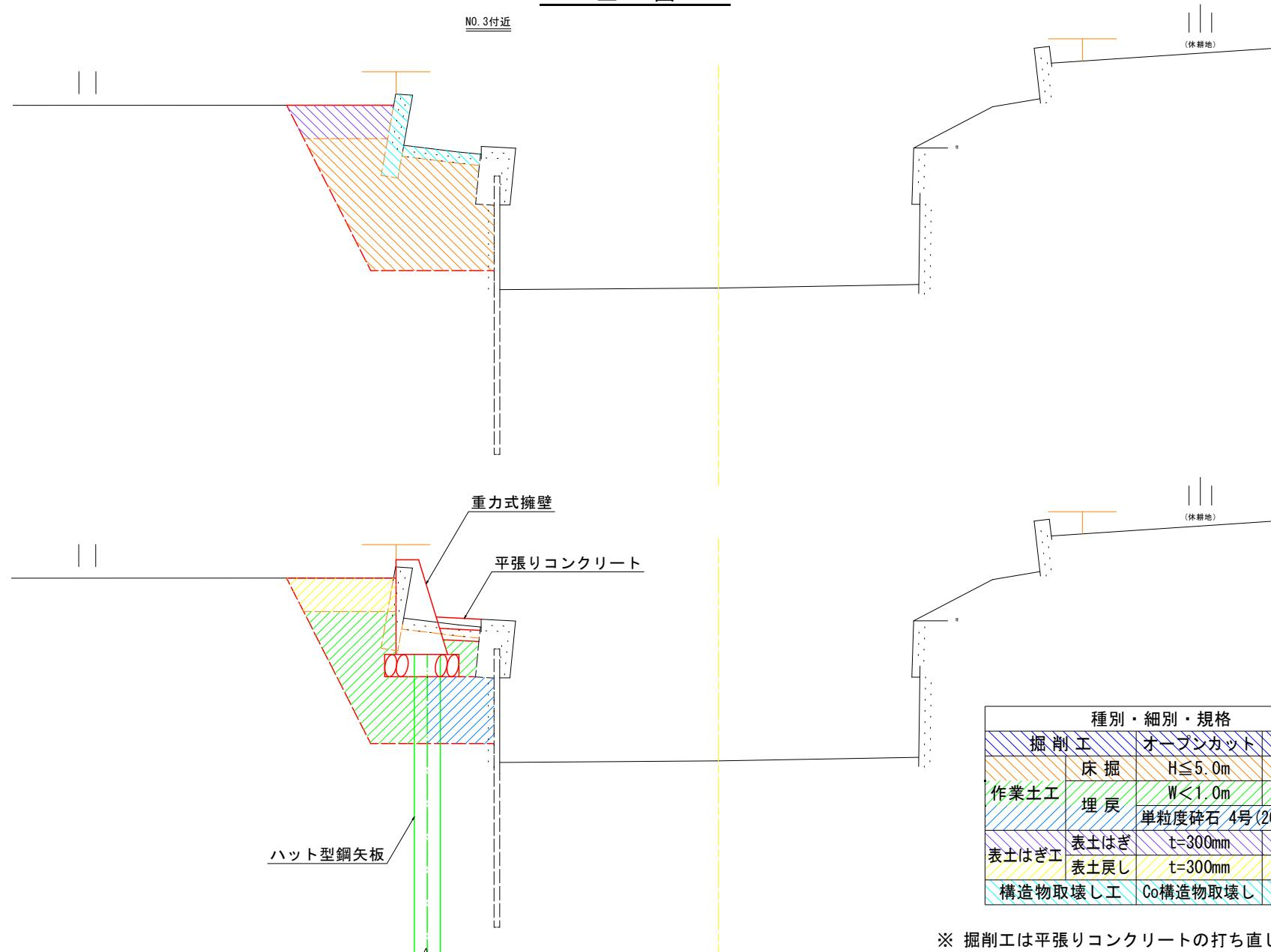
※ 掘削工は平張りコンクリートの打ち直しのみ施工する
